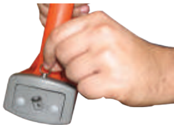
а) Выдвинуть фиксатор, освободить батарейный отсек
