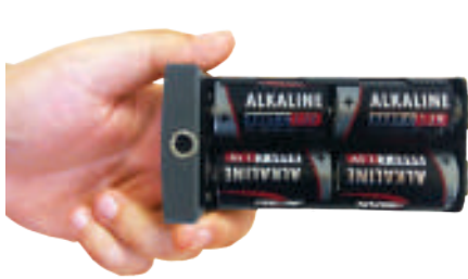
б) Вставить батареи в отсек, соблюдая полярность
